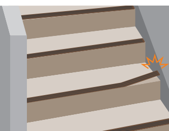
階段の滑り止めの浮き
