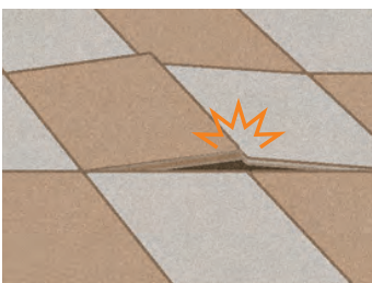
床タイルの浮き
